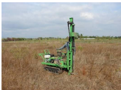
Figure 1 - Sondage au pénétromètre
