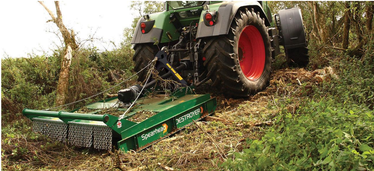
Figure 3 - Débroussaillage avec le Gyrobroyeur
